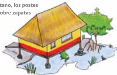
Figura 48. Casa con cimentación elevada recomendable para terrenos pantanosos.
