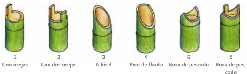
Figura 23. Diferentes tipos de cortes de los culmos de bambú para fabricar uniones en las estructuras.
