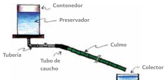
Figura 18. Tratamiento preservador del bambú con el método de Boucherie.
